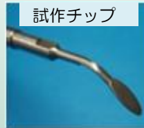
粘膜疾患用超音波チップの試作と振動モード解析
